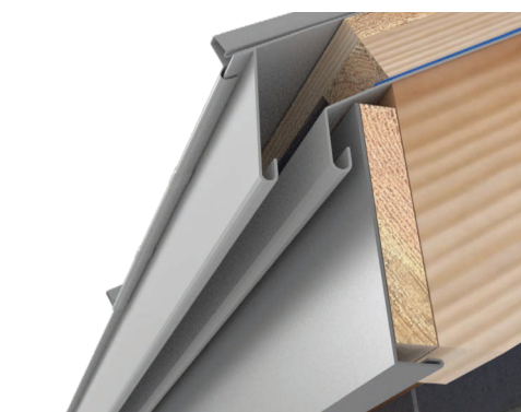
ABB. 11 Über die Traufe hinausgeschobenes Start-Paneel
